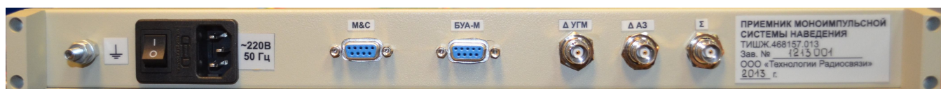
Рисунок 1.2 – Внешний вид задней панели ПМСН
